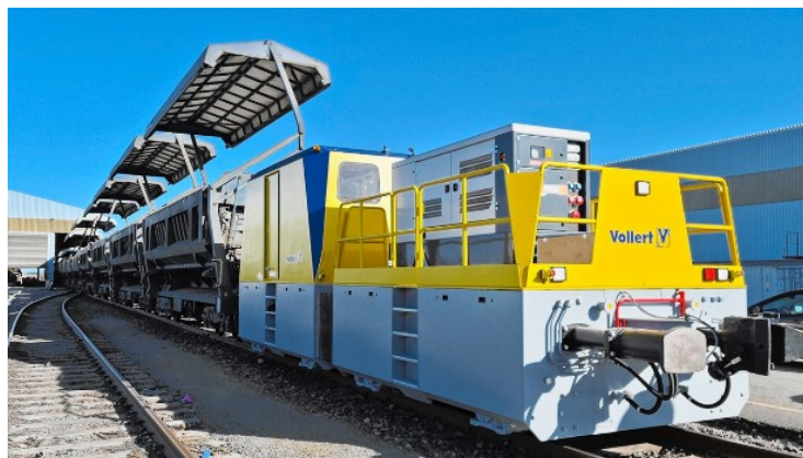
Рис. 41. Дистанционно управляемый по радиоканалу локомотив Tandem DER 150
