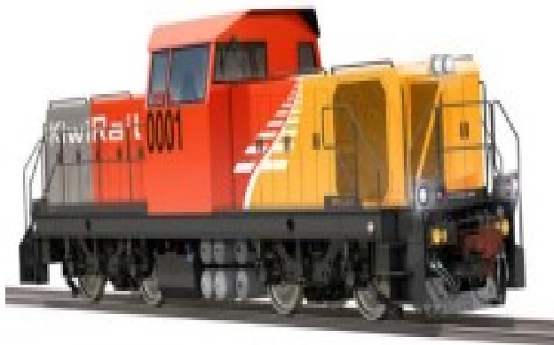
Рис. 3. Гибридный маневровый локомотив Stadler для KiwiRail
