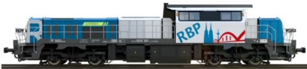
Рис. 34. Гибридный маневровый локомотив Modula hybrid производства Vossloh Rolling Stock
