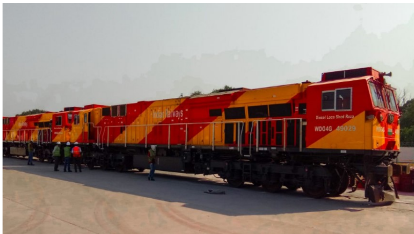
Рис. 22. Дизельный грузовой локомотив Evolution серии ES43ACmi
