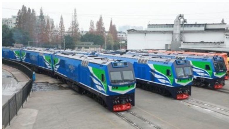
Рис. 36. Новые гибридные локомотивы для колеи 1067 мм производства китайской CRRC Ziyang Co
