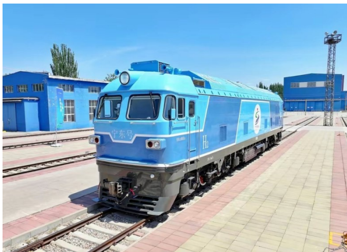
Рис. 38. Ningdong - первый водородный локомотив, преобразованный из тепловоза на дизельном топливе с двигателем внутреннего сгорания
