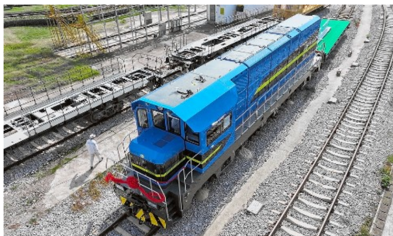
Рис. 39. Первый аккумуляторный маневровый локомотив мощностью 1500 кВт
