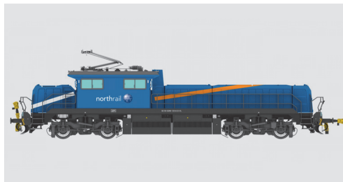
Рис. 4. Электровоз DM 20-EBB с тяговыми аккумуляторными батареями в ливрее компании Northrail
