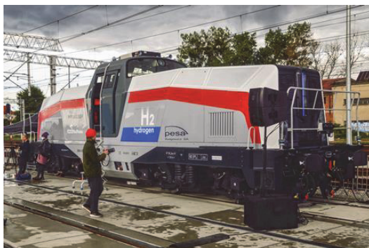
Рис. 6. Маневровый локомотив SM42-6Dn на водородном топливе
