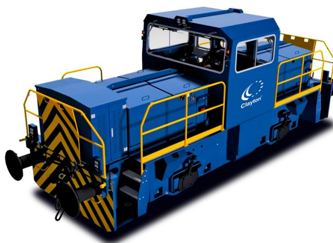
Рис. 53. Электровоз с аккумуляторными батареями СВ45
