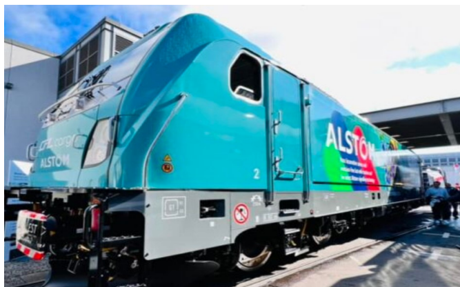
Рис. 29. Электровоз постоянного тока платформы Alstom TRAXX с функцией работы на последней миле
