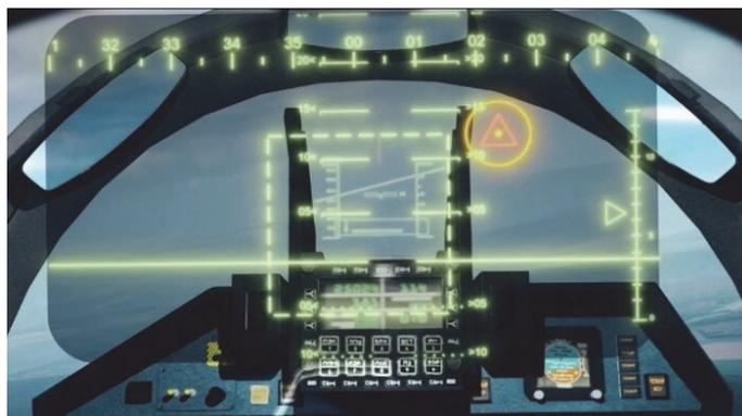
*Рис. 3. Нашлемная система индикации и целеуказания для летчиков*
