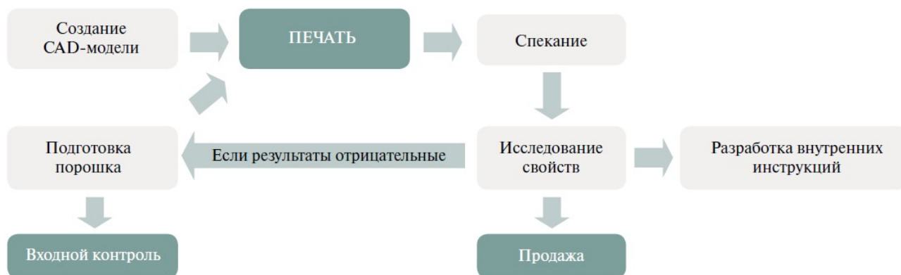
Рис. 7 Блок-схема процесса НИОКР при запуске аддитивных технологий
