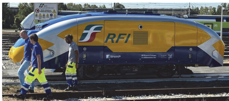
Рис. 23. Прототип URV для автоматизированного контроля высокоскоростных линий
