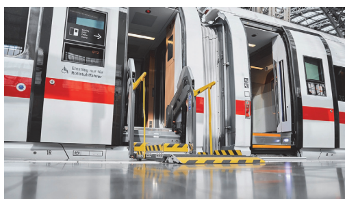
Рис. 18. Подъемник новой конструкции, облегчающий доступ в вагон пассажиров на инвалидных колясках
