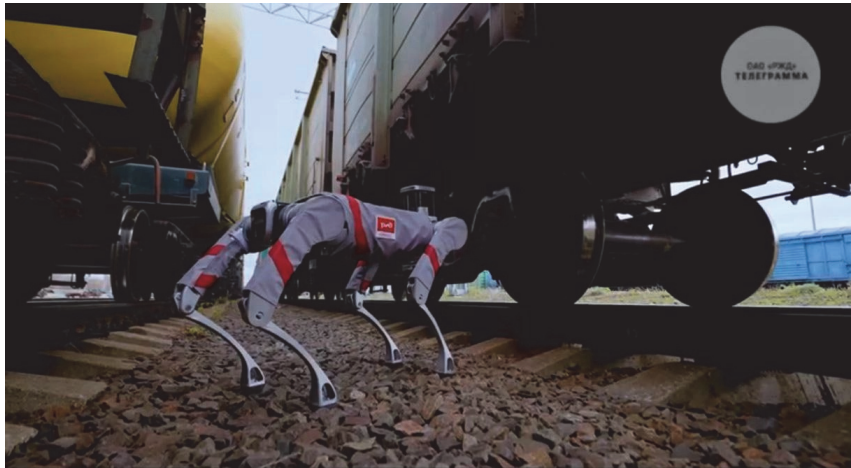
Рис. 1. Биоморфный робот для диагностики подвижного состава и инфраструктуры
