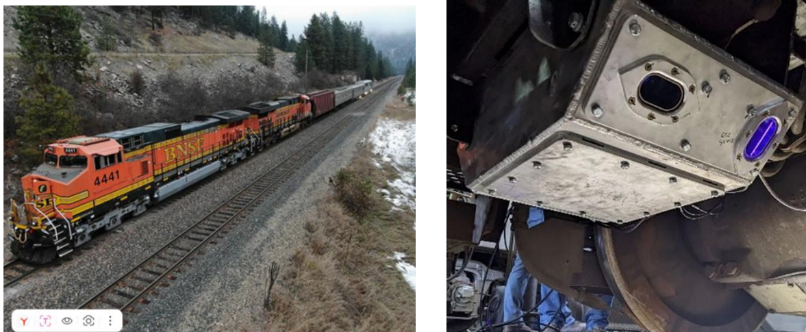
Рис. 4. Бортовая измерительная система ODIN, установленная под локомотивом, для контроля состояния пути
