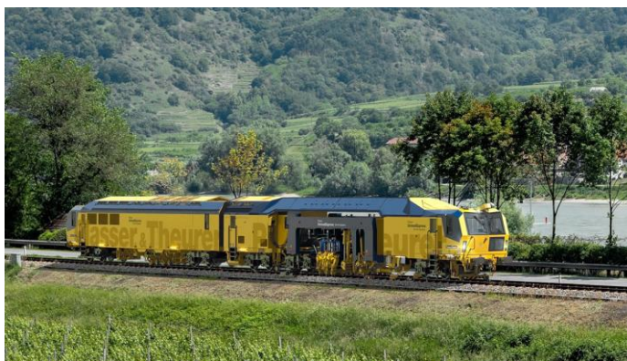
Рис. 5. Подбивочная машина UnimatExpress 2X-4x4 Dynamic
