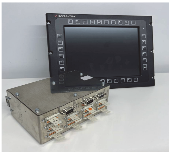
Рис. 3. Микропроцессорная система управления и диагностики МПСУиД
