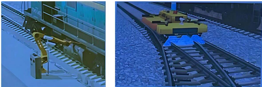
Рис. 1. Робот-заправщик для тепловозов и робот для контроля инфраструктуры
