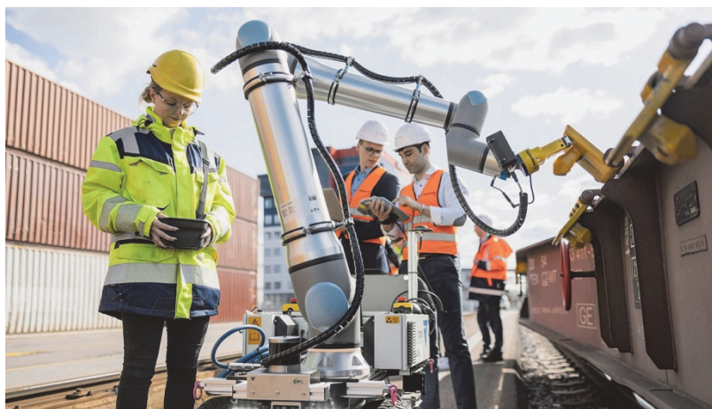
Рис. 2. Робот для перевода фитинговых упоров в нужное положение
