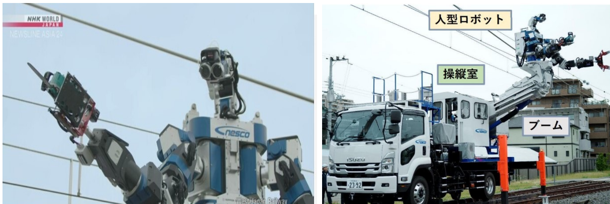
Рис. 2. Робот, установленный на грузовике для техобслуживания и осмотра железнодорожной инфраструктуры
