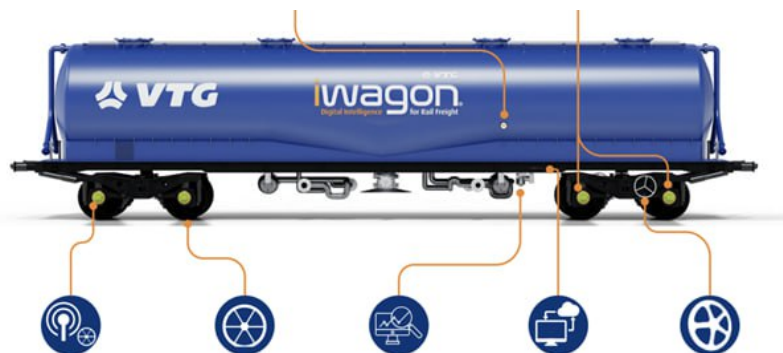
Рис. 4. Система мониторинга грузовых вагонов в режиме реального времени iWagon
