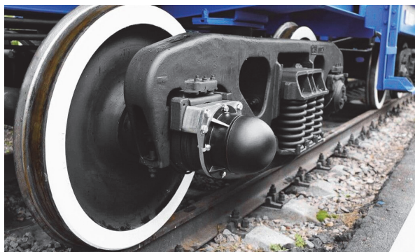
Рис. 1. Тележка 18-9891 с блоком датчиков от НПП «РаТорм»
