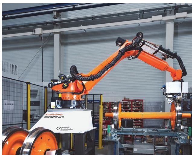
Рис. 5. Автоматизированная система ультразвуковой диагностики железнодорожных колёс Krautkrämer WheelStar RPS
