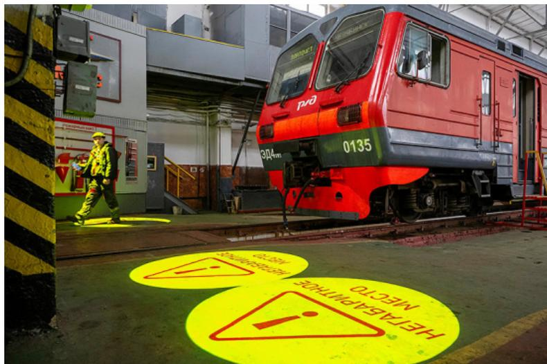
*Рис. 1. Гобо-проекторы в моторвагонном депо*
