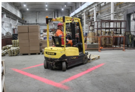
Рис. 5. Гобо-проектор показывает зону опасности при транспортировке грузов
