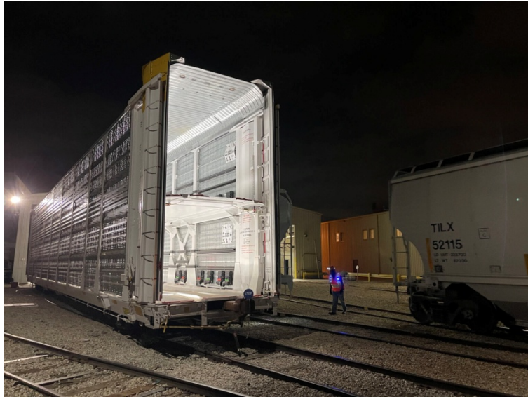
Рис. 2. Модульная система светодиодного освещения INPS, обеспечивающая повышенную яркость внутри грузового вагона
