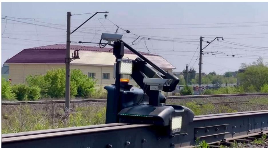
*Рис. 1. Робот-авторасцепщик грузовых вагонов*
