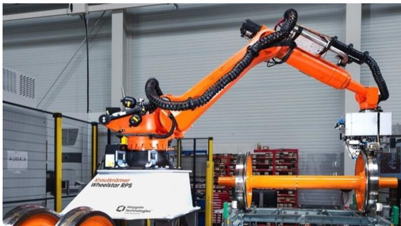
*Рис. 1. Автоматизированная система ультразвуковой диагностики железнодорожных колёс Krautkrämer WheelStar RPS*
