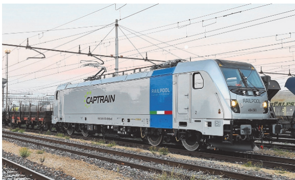
Рис. 4. Электровоз постоянного тока TRAXX DC3
