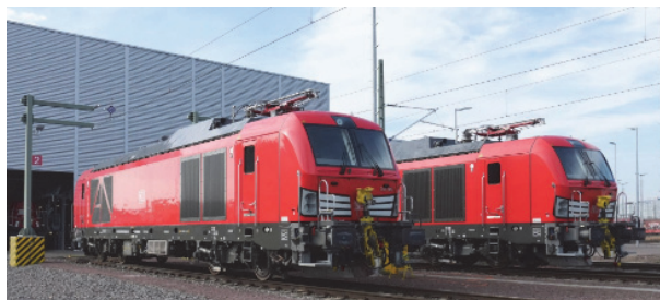
Рис. 8. Новый двухрежимный легкий локомотив Vectron
