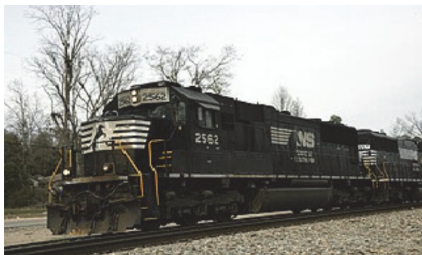
Рис. 6. Тепловоз EMD SD70ACe-BB
