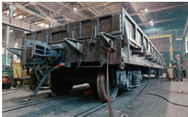
Рис. 12. Универсальный вагон-платформа модели 13-5993
