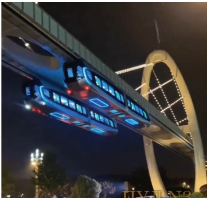
Рис. 3. Подвесной монорельс в виде «перевернутого поезда»
