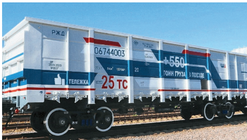
Рис. 4. Полувагон с разгрузочными люками модели 12-6744
