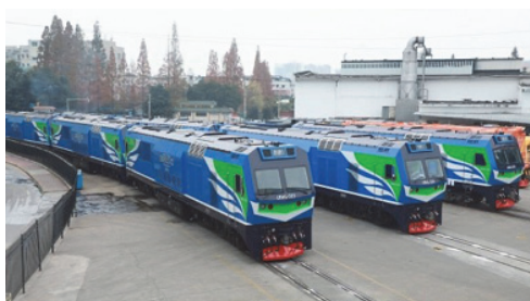
Рис. 3. Новые гибридные локомотивы для колеи 1067 мм производства китайской CRRC Ziyang Co
