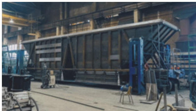
Рис. 8. Вагон-хоппер модели 22-5223 для перевозки сухого охлажденного кокса
