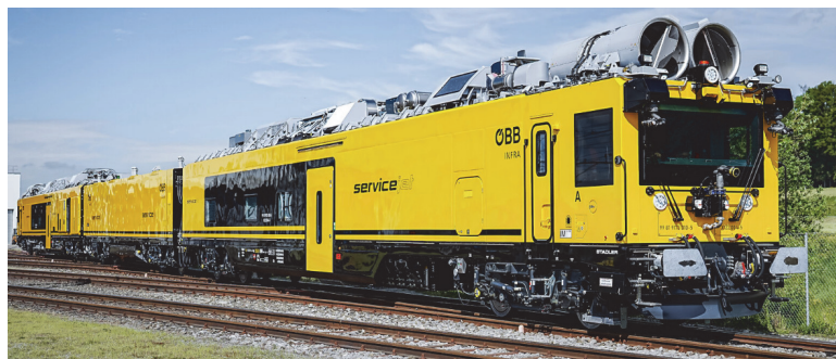
Рис. 10. Гибридный спасательный поезд ÖBB Servicejet
