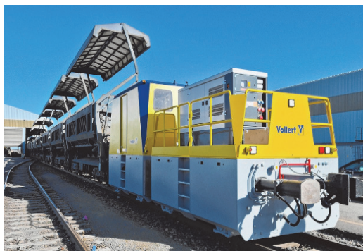
Рис.3. Дистанционно управляемый по радиоканалу локомотив Tandem DER 150
