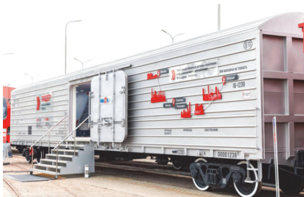
Рис. 6. Вагон-термос изотермический для перевозки скоропортящихся грузов модели 16-1239
