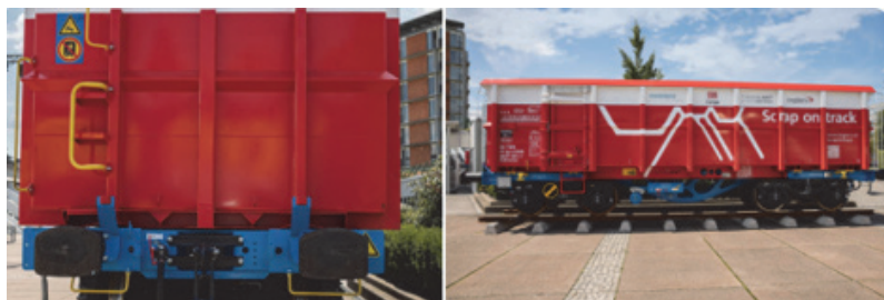
Рис. 3. Кузовной модуль TransANT нового поколения для перевозки металлолома
