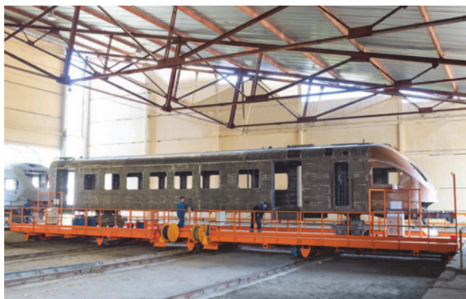
Рис. 6. Трансбордер большей грузоподъемности для перемещения вагонов между цехами
