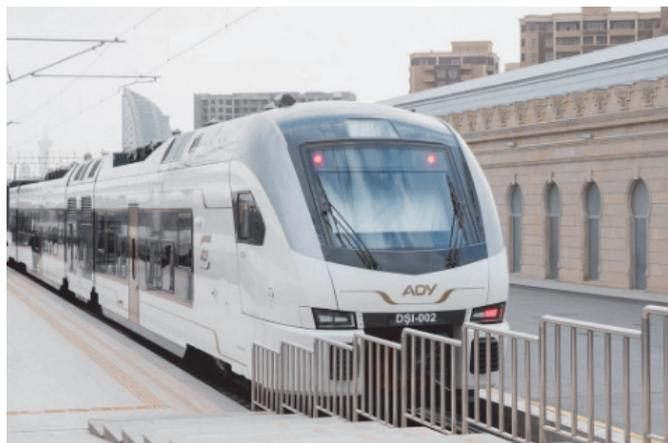
*Рис. 4. Дизель-поезд семейства FLIRT производства Stadler*
