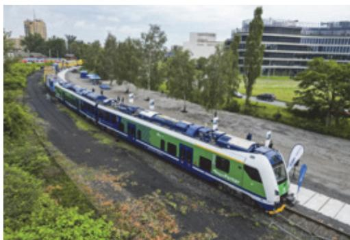
*Рис. 1. Подвижной состав был создан в 2022-м на основе традиционной платформы частично низкопольных одноэтажных поездов Skoda Group – 7Ev*
