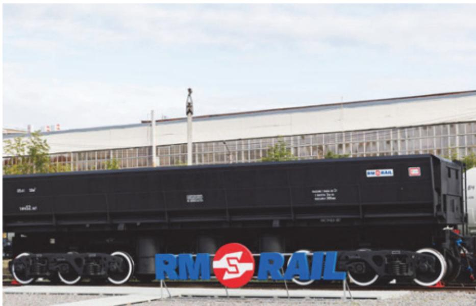
*Рис. 1. Шестиосный вагон-самосвал модели 33-1297*
