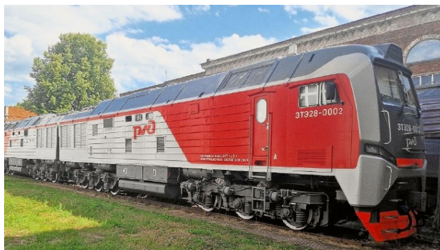
Рис. 4. Магистральный грузовой тепловоз 3ТЭ28
