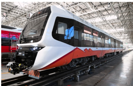
Рис. 8. Шестиосный двухсекционный поезд, оснащенный литий-ионными аккумуляторами
