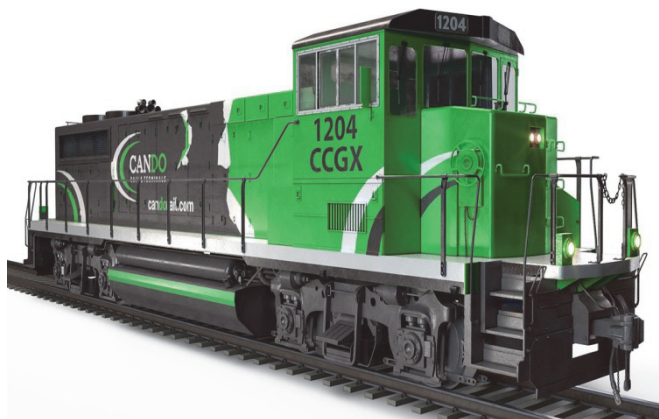
Рис. 10. Рендер тепловоза SW1200, который планируется перевести на аккумуляторную тягу.
