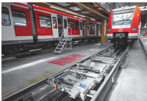
Рис. 8. Роботизированная тележка для инспектирования подвагонного оборудования
