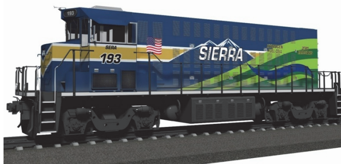
Рис. 9. Рендер тепловоза RP20BD, который планируется перевести на водородную тягу.
