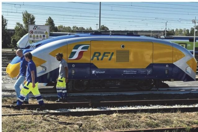
*Рис. 4. Автономный инспекционный вагон для диагностики полотна высокоскоростных железных дорог*
