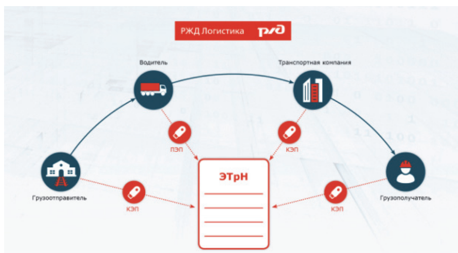
Рис. 6. Использование электронны транспортных накладных (ЭТрН) при реализации мультимодальной перевозки
