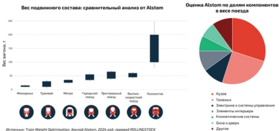
Рис. 4. Инфографика со сравнением показателей массы тары для разного подвижного состава
