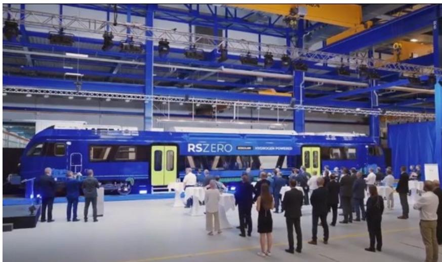
*Рис. 9. Прототип водородного рельсового автобуса RS ZERO*
