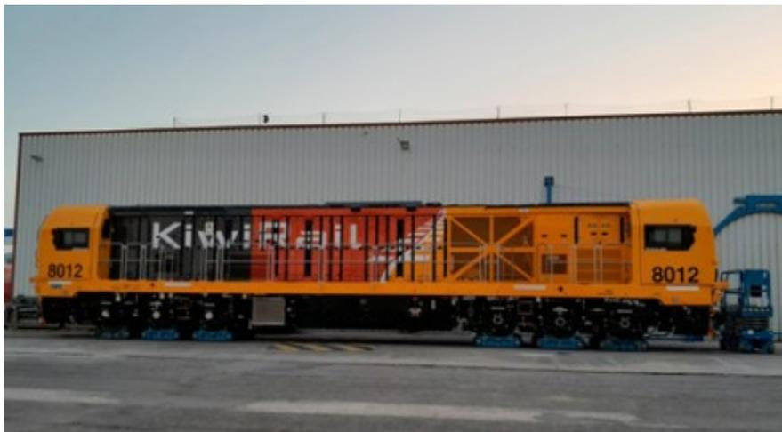
*Рис. 10. Тепловоз класса DM*
