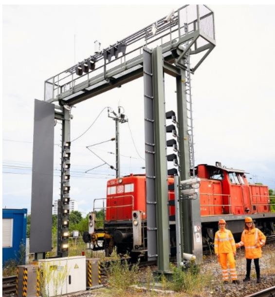
*Рис. 13. DB Cargo дополняет искусственным интеллектом диагностические порталы на станциях*
