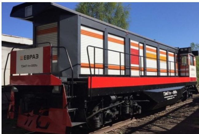
Рис. 4. Маневровый тепловоз ТЭМП-1тт
