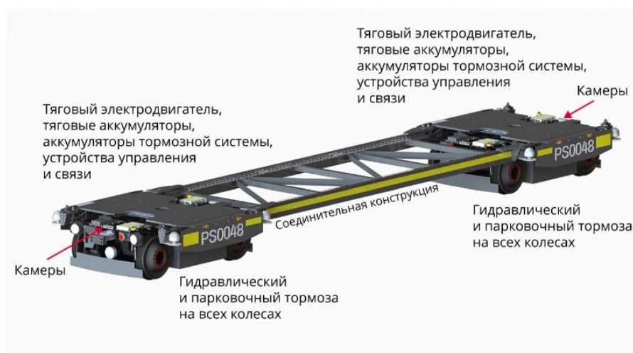
Рис. 1. Беспилотный рельсовый экипаж с тяговым аккумулятором, разработанный компанией Parallel Systems
