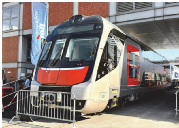
*Рис. 8. Головной вагон электропоезда серии D (Mariyung)*
