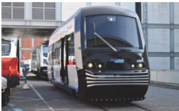
*Рис. 6. Прототип аккумуляторного рельсового автобуса*
