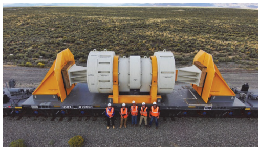
Рис. 2. Вагон Atlas для перевозки ОЯТ и ВАО
