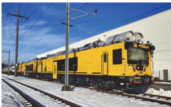
Рис. 4. Гибридный пожарно-спасательный поезд Servicejet от Stadler
