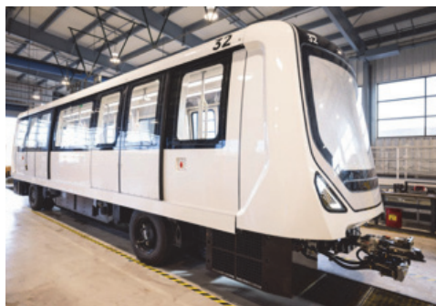
Рис. 5. Вагон беспилотного поезда Alstom на шинном ходу
