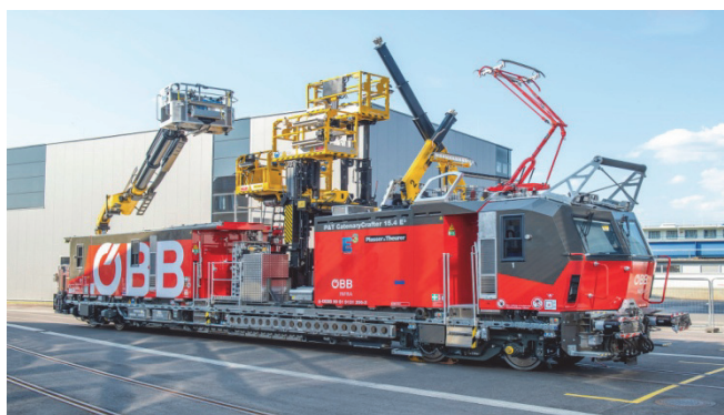
Рис. 1. Путевая машина модели CatenaryCrafter 15.4 E 3 от Plasser & Theurer.
