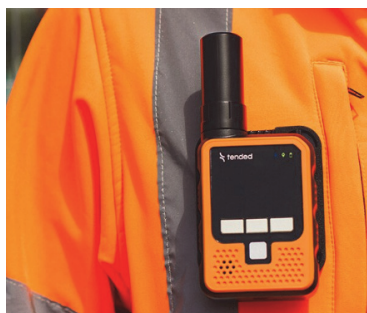
Рис. 13. Носимое устройство уведомляет работников о выходе из безопасной зоны
