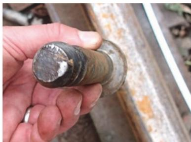
*Рис. 7. Верхняя часть винта с признаками разрушения и последующего выхода из излома в результате перегрузки*
