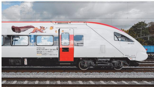
Рис. 4. Электропоезд из вагонов с наклоняемыми кузовами InterCity
