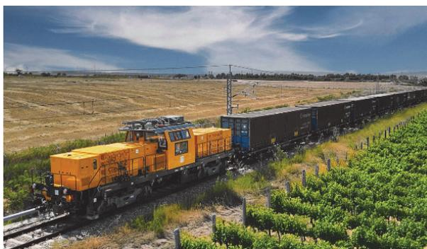
*Рис. 6. Контактно-аккумуляторный локомотив постройки CAF*
