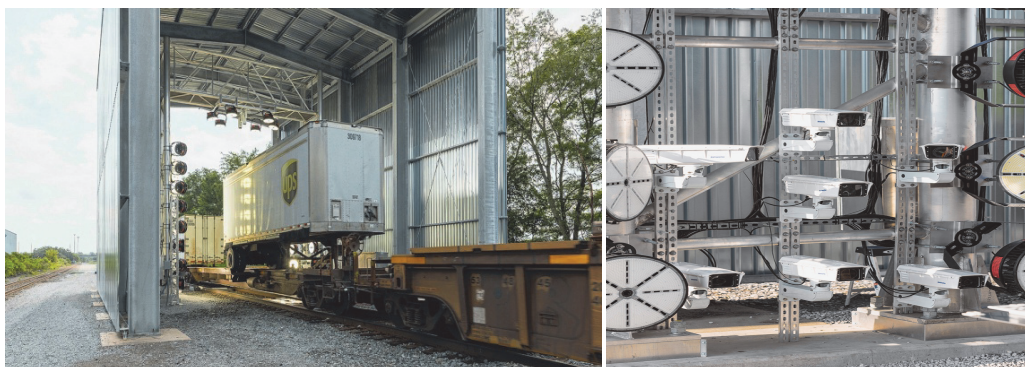
Рис. 3. Цифровой инспекционный портал на основе ИИ
