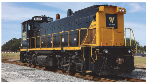
Рис. 11. Локомотив на аккумуляторных батареях Watco
