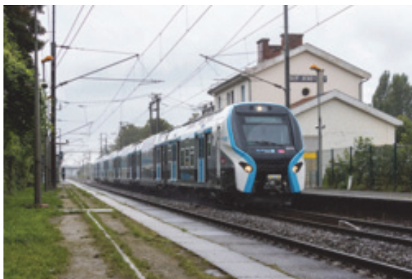
Рис. 7. Состав с переменной этажностью
