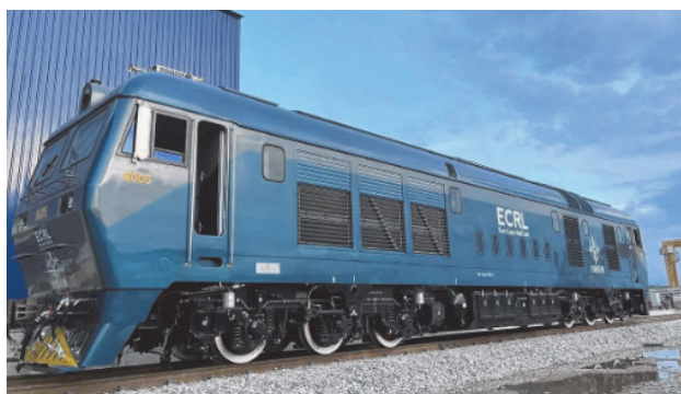
Рис. 10. Шестиосный тепловоз с электрической передачей переменного-постоянного тока
