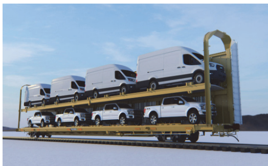
Рис. 4. Размещение автомобилей в вагоне Multi-Max Plus
