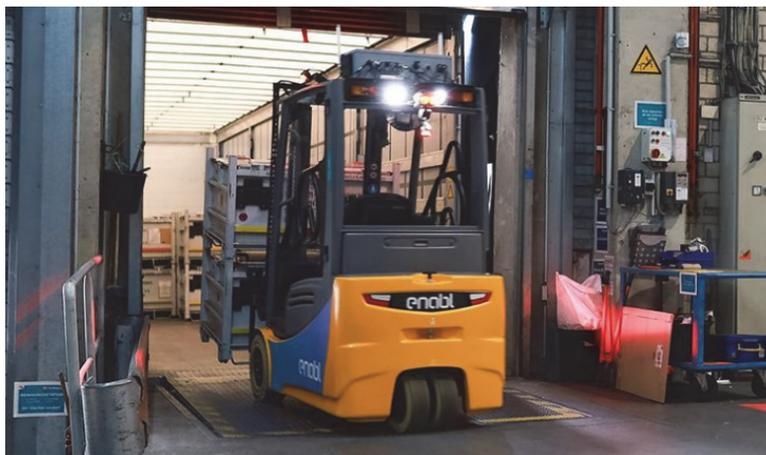
*Рис. 7. DB Schenker в г. Карлсруэ ввела в эксплуатацию вилочные погрузчики с дистанционным управлением*
